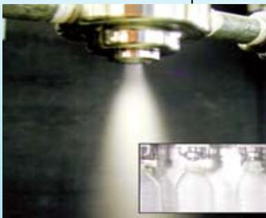
Как только бутылка ставится в нужное положение, прецизионная форсунка выпускает смесь перексусной кислоты с горячим паром. Регулирование количества жидкости производится посредством дозирочного насоса. Чтобы обеспечить одновременный подвод пара и жидкости, открытие и закрытие производится магнитными клапанами.
