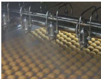
На выходе из печи форсунки равномерно распыливают воду на хлеб, в результате чего образуется аппетитная хрустящая корочка
