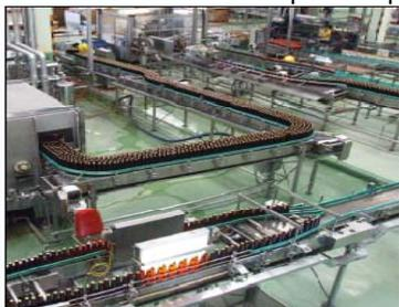
Современные, автоматические высокопроизводительные линии розлива предъявляют высокие требования к бесперебойной подаче и отводу наполняемой тары. Точно дозированный слой водных смазочных растворов в точных, соответствующих потребностям, концентрациях уменьшает сопротивление, трение между движущимися деталями, уменьшает износ и, вместе с тем, предотвращает остановки в производстве.
